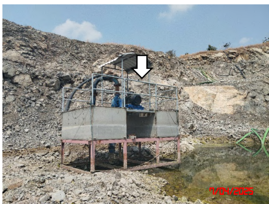
รูปที่ 4 บ่อรองรับน้ำ (Sump)
