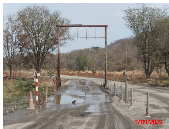
รูปที่ 11 จุดล้างล้อรถบรรทุกก่อนขนส่งแร่
